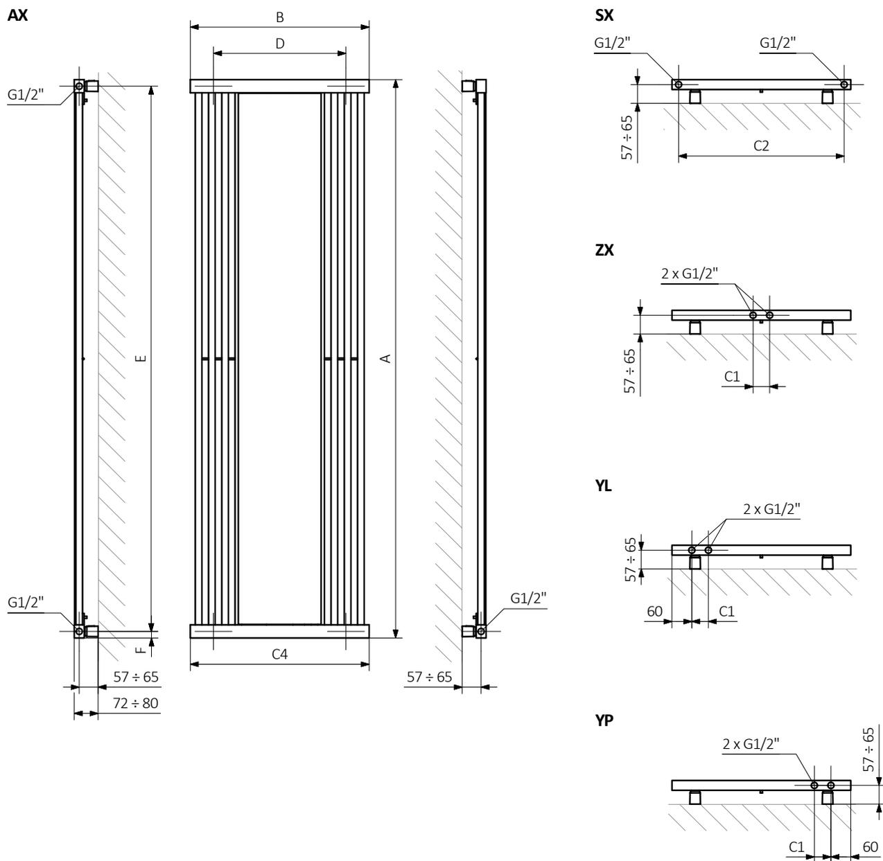
A — высота B — ширина C1-C5 — Расстояние между осями подключения D — расстояние между осями крепежей по горизонтали E — расстояние между осями крепежей по вертикали F — расстояние от оси нижнего крепежа до нижнего края коллектора
