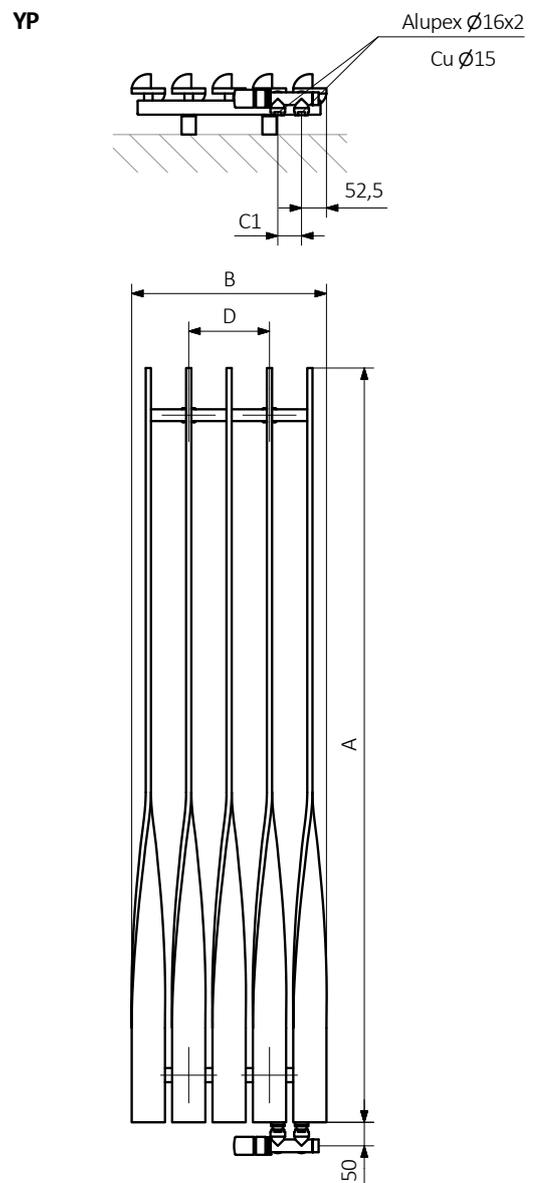
A — высота B — ширина C1-C5 — Расстояние между осями подключения D — расстояние между осями крепежей по горизонтали E — расстояние между осями крепежей по вертикали F — расстояние от оси нижнего крепежа до нижнего края коллектора
