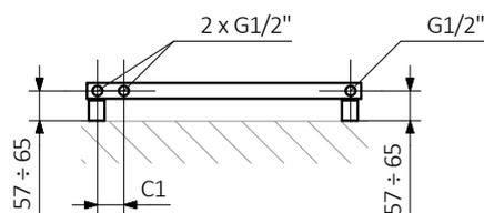
A — высота В — ширина C1-C5 — Расстояние между осями подключения D — расстояние между осями крепежей по горизонтали E — расстояние между осями крепежей по вертикали F — расстояние от оси нижнего крепежа до нижнего края коллектора
