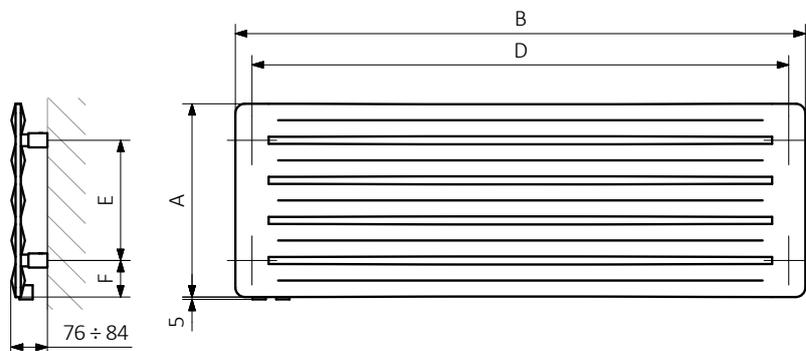
A — высота В — ширина C1-C5 — Расстояние между осями подключения D — расстояние между осями крепежей по горизонтали E — расстояние между осями крепежей по вертикали F — расстояние от оси нижнего крепежа до нижнего края коллектора
