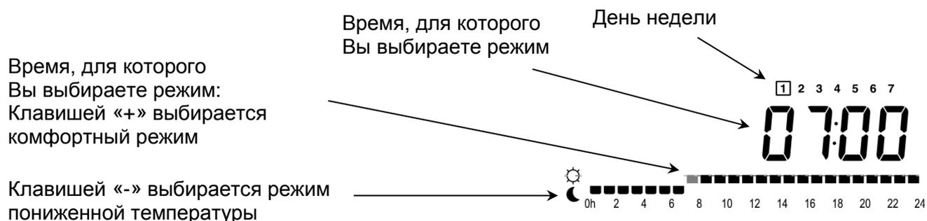
С помощью клавиш ◀▶ передвигайтесь по графической схеме дневной программы и клавишами «+» и «-» ставьте в соответствии выбранному часу (мигает) комфортный или пониженный уровень температуры. Задав программу для одного дня, нажмите **OK** для перехода к следующему дню. Нажатие клавиши **OK** после программирования седьмого дня подтверждает всю недельную программу и возвращает Вас в главное меню.
